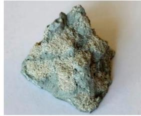
**Рисунок 2** – Скол образца-куба с гранулированным заполнителем (фракция песка  $\leq 0,63$  мм)
