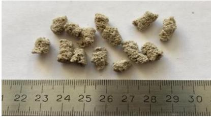
**Рисунок 1** – Гранулированный заполнитель (фракция песка  $\leq 0,63$  мм)
